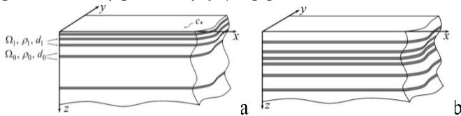
Рис. 1. Структура багатошарового півпростору для ерлангівського розподілу включень при ступенях вільності  $n = 2$  (a) і  $n > 2$  (b)
