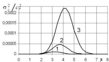
Рис. 2. Дисперсія поля концентрації в різni моменти безрозмірного часу  $\tau = 0,3; 0,4; 0,5$  (криві 1-3) при  $\mu = 0,5$ ,  $n = 10$
