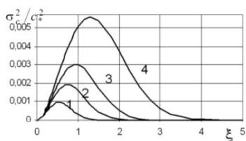
Рис. 3. Дисперсія поля концентрації в різni моменти безрозмірного часу  $\tau = 0,2; 0,3; 0,4; 0,6$  (криві 1-4) при  $\mu = 10$ ,  $n = 1$  (а)
